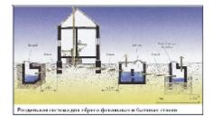
Слив делают от раковин, приборов и в полу (ванная, котельная, даже на кухне можно). Для остановки запаха делают гидрозатвор («змейку»). В туалете основной стояк часто имеет выход наверх. Трубы вниз ведут с небольшим уклоном. Под е. правильно делать септик. Хотя есть и автономные устройства. В лучших системах фекалии нужно удалять достаточно редко (раз в год). В лучших системах не машина всё отсасывает, а вы с этого делаете ценное удобрение, как раз через год оно почти и готово.
